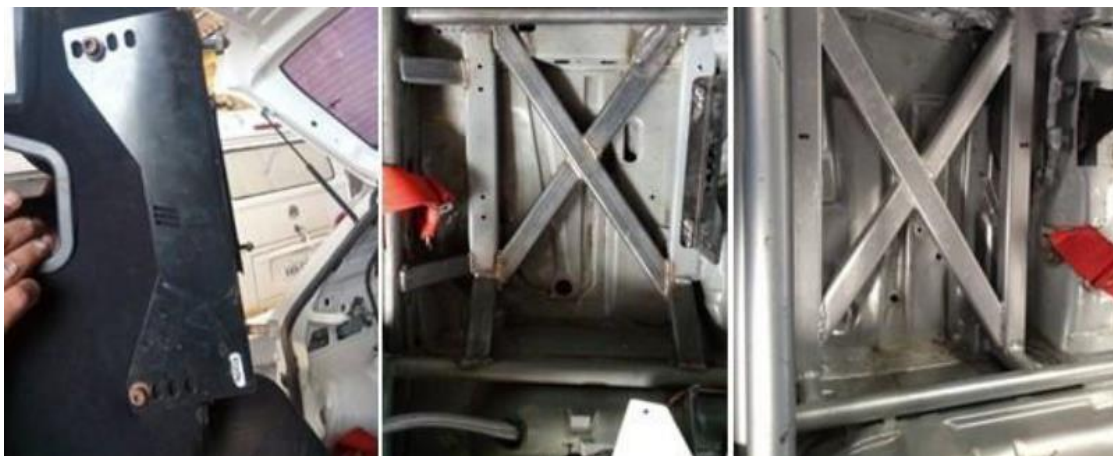
Suporte do Banco (Fixação Lateral) / Prolongamento Santantônio para fixação do banco.
